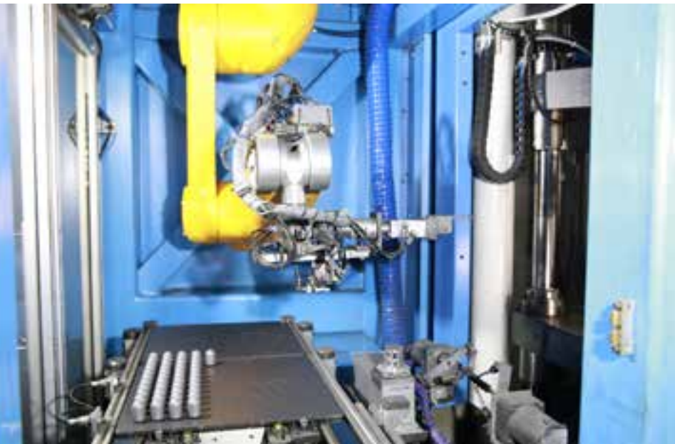
十大创新成果之一——中钨高新机械手动去毛刺装置改进项目
